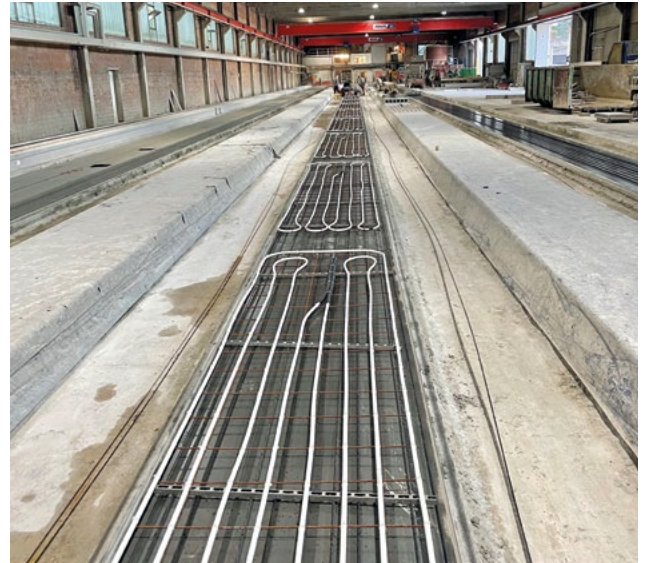
Thermisch aktivierte Spannbetonfertigdecken werden werkseitig mit vorgefertigten Modulen zum Heizen/Kühlen ausgestattet.
